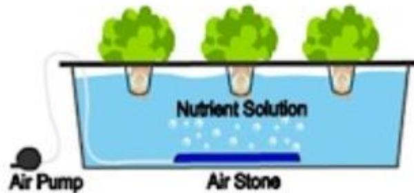
**Gambar 2.19 Hidroponik dengan teknik Rakit Apung**
