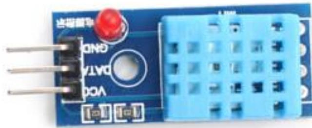
**Gambar 2.4 Sensor DHT11**
