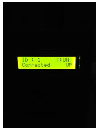
Gambar 21. Implementasi Perangkat Keras kondisi saat hardware melakukan upload data ke database dan status koneksi Connected
