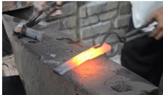
Gambar II.8 Proses Penempaan Logam Panas
