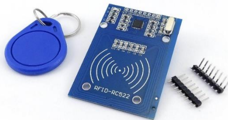
Gambar 2.2 Modul RFID MFRC522
