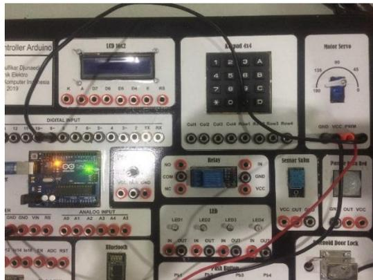
**Gambar 4. 19** Uji coba rangkaian motor Servo
