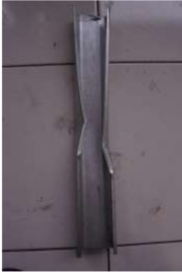
Gambar 4.4 Tekuk Lokal Profil C50
