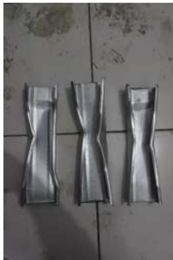
Gambar 4.2 Tekuk Lokal Profil C30
