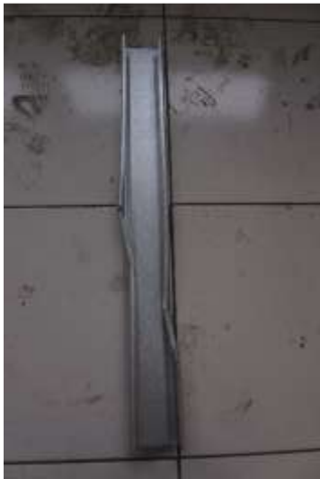
Gambar 4.6 Tekuk Lokal Profil C75
