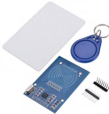
Gambar 2.1 RFID Reader, Tag, dan Kartu RFID
