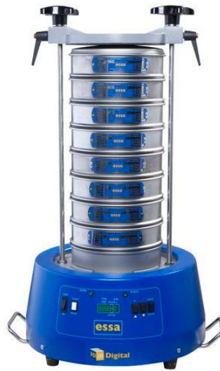
Gambar 2.1 Salah Satu Contoh Sieve Shaker yang Sudah Ada
