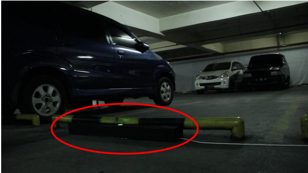
Gambar 4.7. Alat Mikrokontroler Slot Parkir
