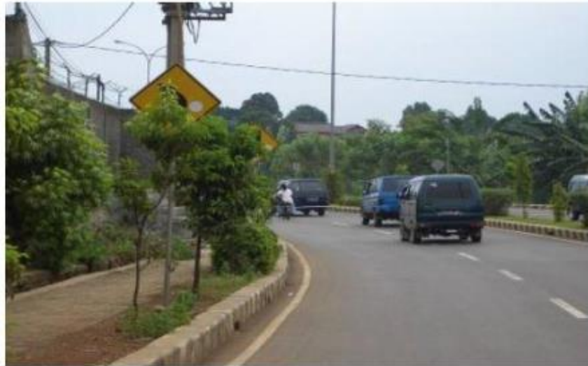
Gambar 2.11 Rambu Tidak Boleh Terhalang
