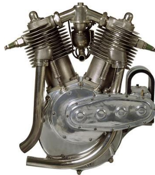
Gambar II. 3 Mesin motor Harley Davidson Bermesin V-Twin Pertama
