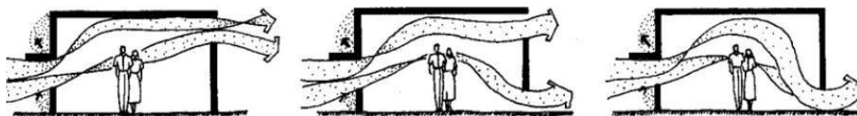
Gambar 3 Sirkulasi udara melalui ventilasi
