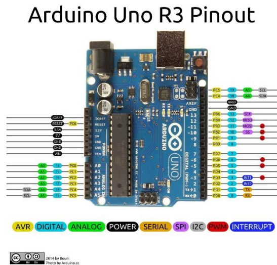
Gambar 2.2 Skema Pin GPIO Arduino Uno
