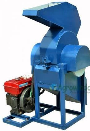
*Gambar 2.19 Mesin Pencacah Plastik*
