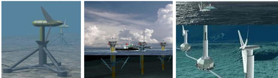
Gambar 5. 7 Berbagai jenis turbin lepas pantai yang digerakkan oleh arus pasang surut. (dari berbagai sumber)
