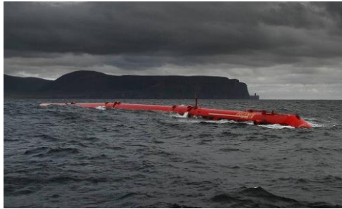
Gambar 5. 2 alat pelamis salah satu alat pembangkit listrik tenaga ombak.
