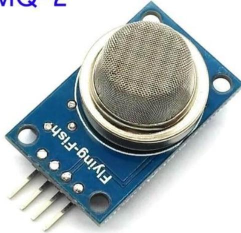
**Gambar 2.13** Sensor Asap MQ2
