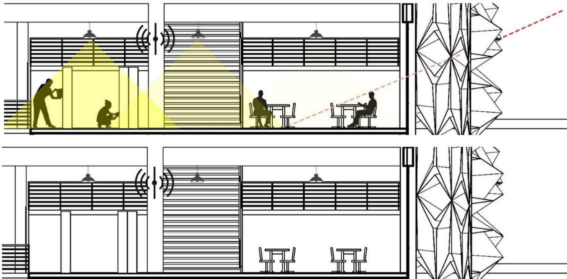
Gambar 5. 12 Diagram Otomatisasi Pencahayaan dan Facade Kinetik
