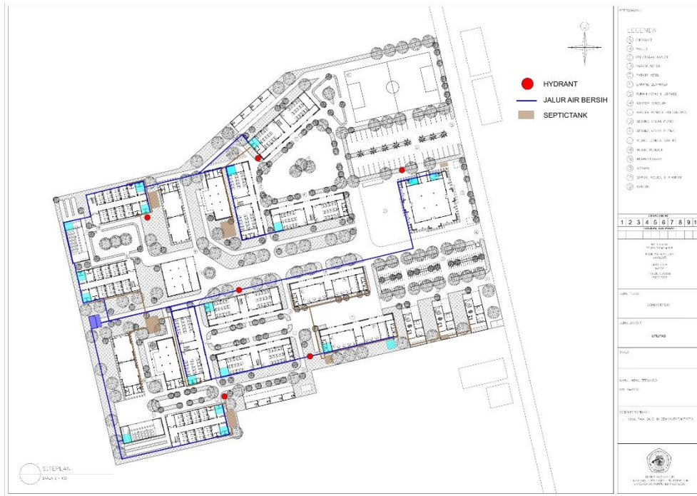
Gambar 6. 25 Utilitas Air Bersih & Air Kotor
