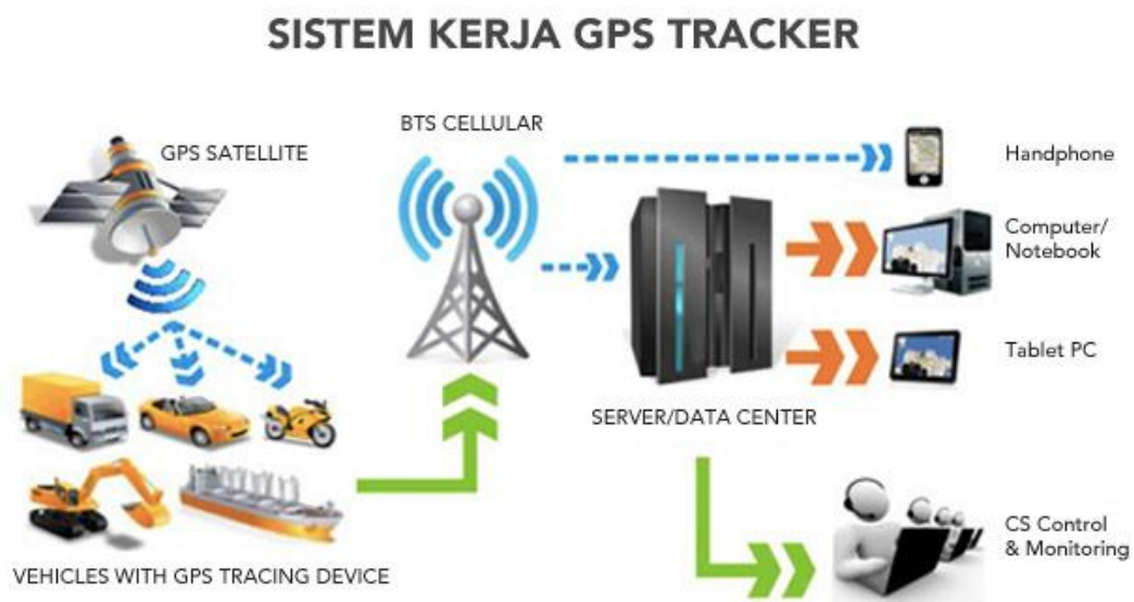
Gambar 0.9 Sistem Kerja GPS Tracker
