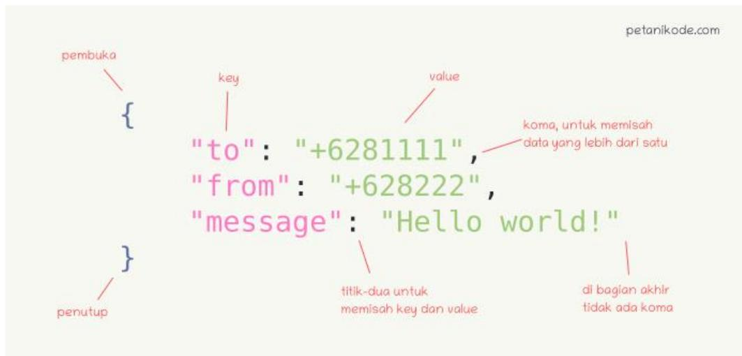
Gambar 2.4 Struktur JSON
