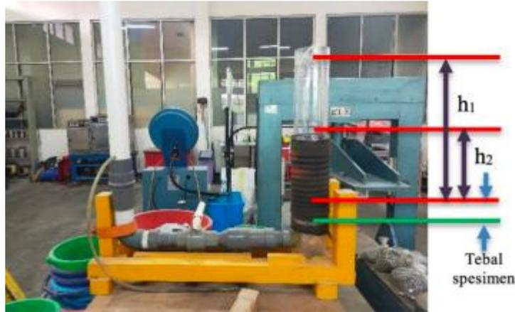
Gambar II. 5 Alat Uji Permeabilitas
