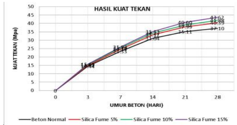
Gambar II. 12 Presentase Perbandingan Kuat Tekan Beton Menggunakan Silica Fume dengan Beton Normal
