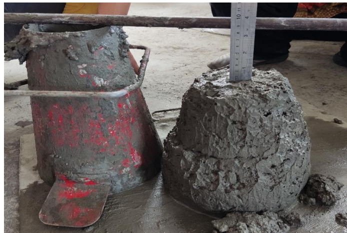
Gambar IV. 4 Proses Pengujian Slump
