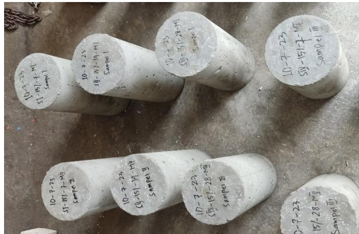
Gambar IV. 1 Sampel Beton Yang Telah Diberikan Kode Sumber: Penelitian di Laboratorium B4T Sangkuriang Dago
