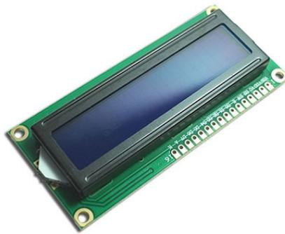
**Gambar 2.3.** LCD 16x2
