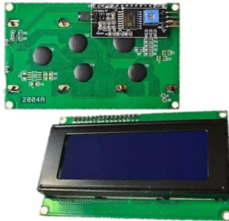
Gambar 2.4 Contoh LCD 20x4 dengan I2C
