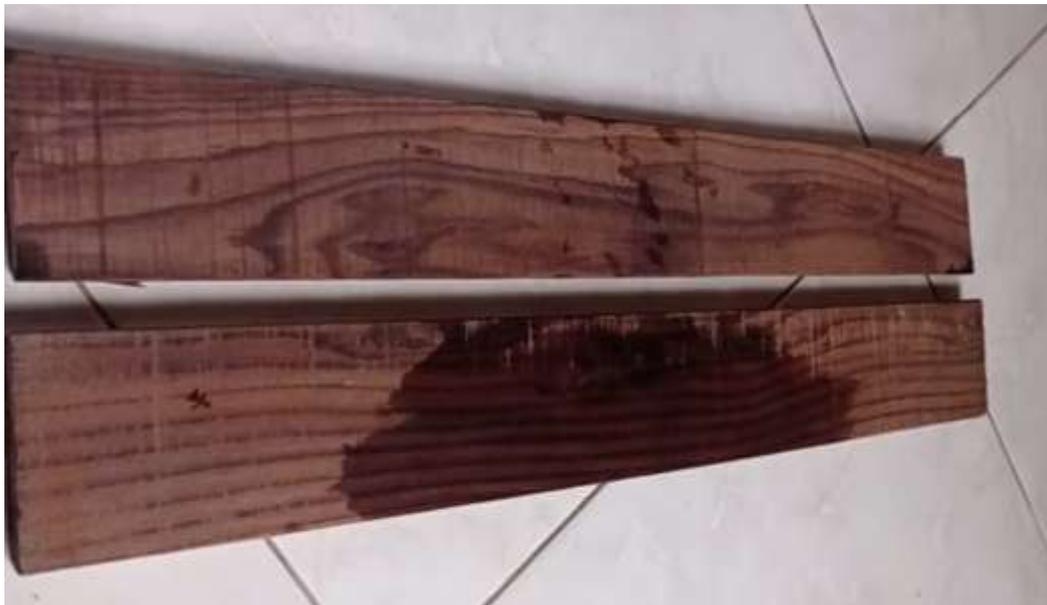
Gambar II.2 Kayu sonokeling untuk bahan bagian gagang atau serangka golok
