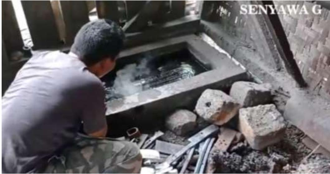
Gambar II.3 Proses penyepuhan besi
