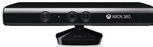
Gambar 2. 3 Sensor Inframerah 1M IR Laser dan Aptina MT9M001 CMOS pada Kinect XBOX 360 [4]
