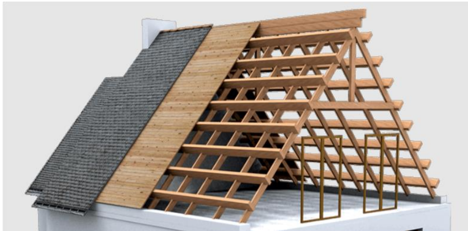
Gambar 5. 11 Struktur atap bitumen sumber : indobitumen.com
