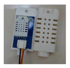
Gambar 2.3 Sensor DHT22
