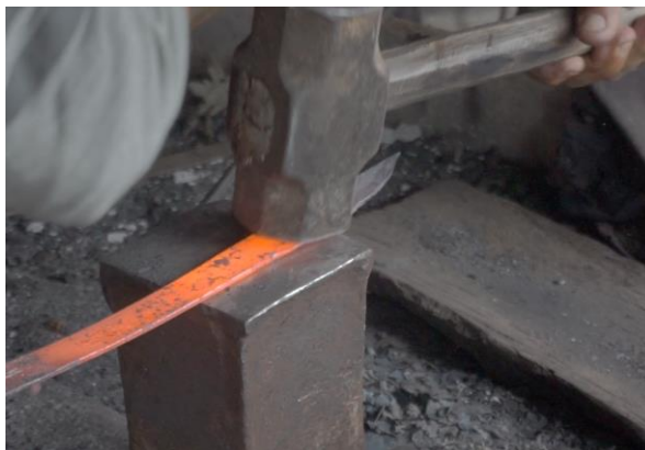
Gambar II.18 Proses Penempaan Sumber : Dokumentasi Pribadi
