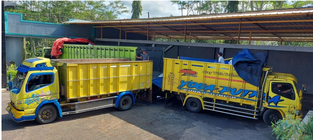
Gambar II.2. Truk sumbu 2 roda 6 yang menggunakan bak kayu Sumber : Sumber Pribadi (2022)
