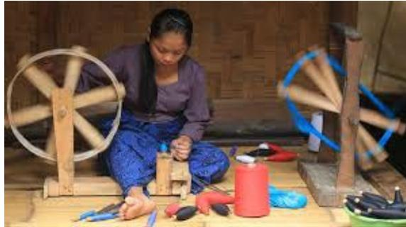
Gambar 5.19 Proses Penggulungan Benang Untuk Membuat Tenun
