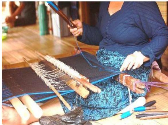
*Gambar 5.22 Proses Menyucuk Untuk Membuat Tenun
