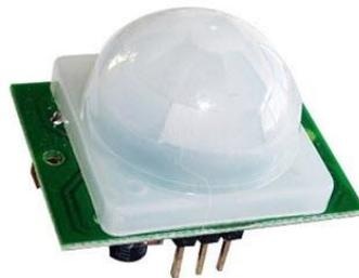
**Gambar 2.13 Sensor infra merah pasif**
