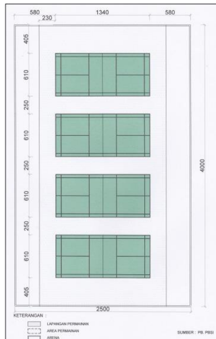
Gambar 2.7 GOR Tipe B Tata Letak 4 Lapangan Bulu Tangkis untuk Pertandingan
