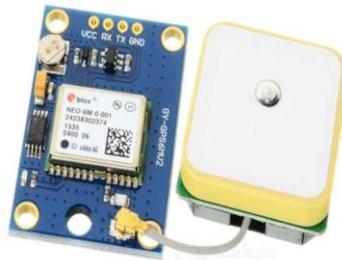
Gambar II- 4: Modul GPS U-blox Neo6m
