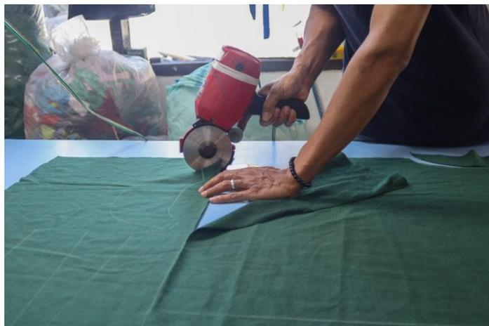
*Gambar 2.74 Proses Pemotongan Kain*
