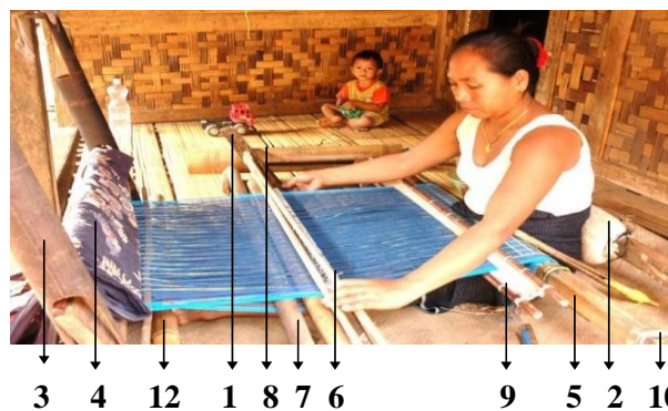
Gambar 2. 9 Bagian-bagian Alat tenun Baduy
