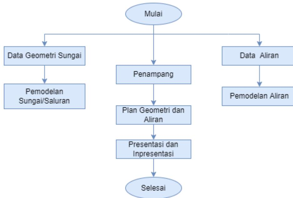
**Gambar 2. 9 Diagram Alir Perhitungan Hidrolika Menggunakan Program HEC-RAS**
