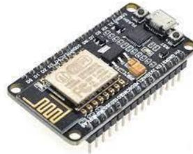
Gambar 2.4 NodeMcu
