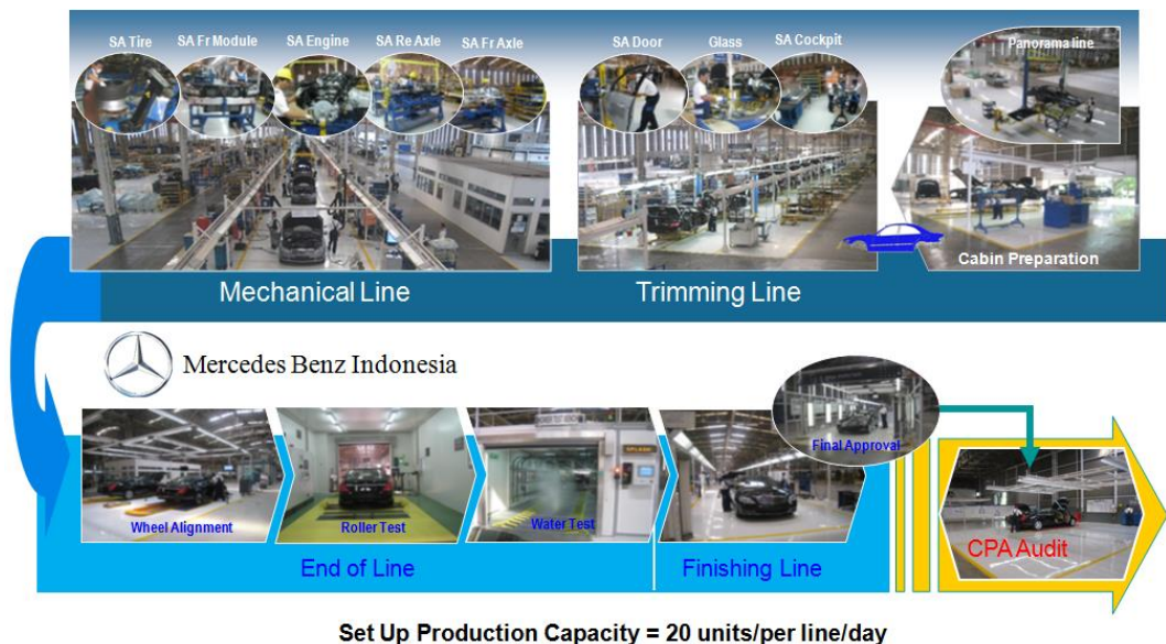
Gambar 2.6 Proses Assembly mobil sedan dan suv PT. Mercedes Benz Indonesia
