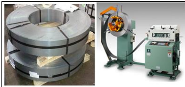
Gambar 5.5 Baja Coiler dan Feeder
