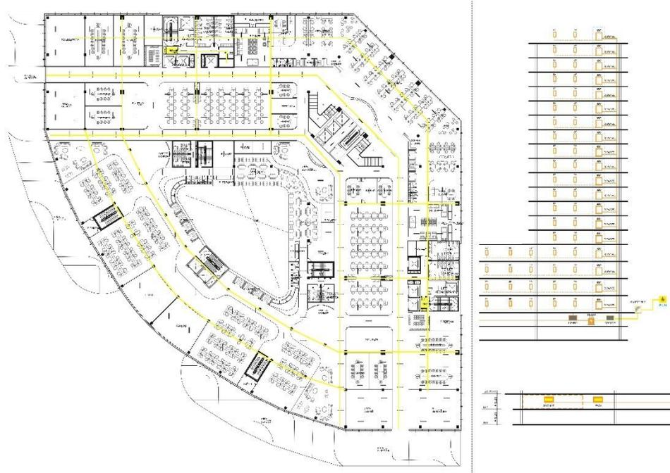
Gambar 5. 13 Sistem Instalasi Listrik (Sumber: Data Pribadi)
