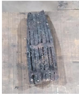
Gambar II.6 Plat Besi, Nikel, dan Baja yang sudah di satukan Sumber: Dokumentasi Pribadi
