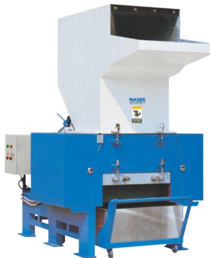
Gambar 2. 17 Mesin pencacah plastik berukuran 180 x 90 x 135 cm
