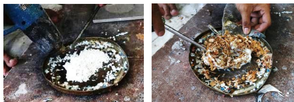
Gambar 2. 8 Proses pelelehan plastik dan pencampuran dengan serbuk kayu menggunakan heatgun
