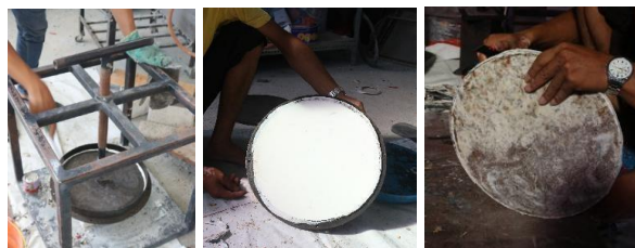
Gambar 2. 11 Proses compressing hasil campuran kayu dan plastik
