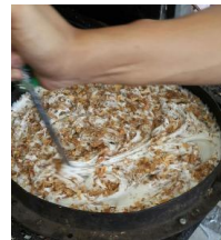
Gambar 2. 10 Proses pencampuran kayu dan lelehan plastik di cetakan
