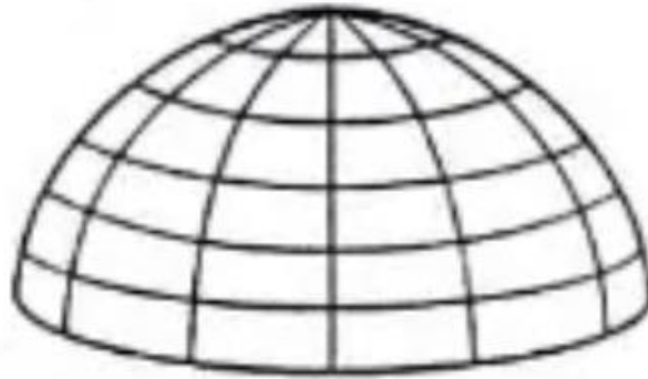
Gambar 2. 6 Struktur Cangkang Sumber : Schodeck (2014)
