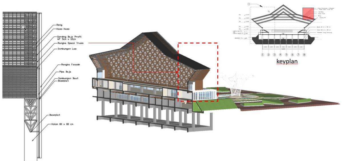
Gambar 5. 16 Fasade Bangunan Panel Metal
