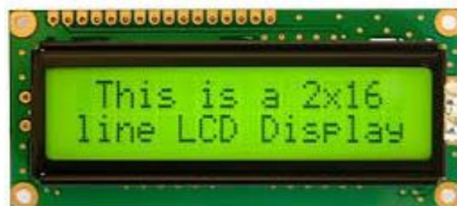
Gambar 2.6 LCD 16X2
