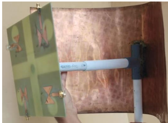
Gambar 3.28 Penggabungan Pipa Paralon Dan Mengatur Jarak Antena Dengan Coner Reflektor 90°
