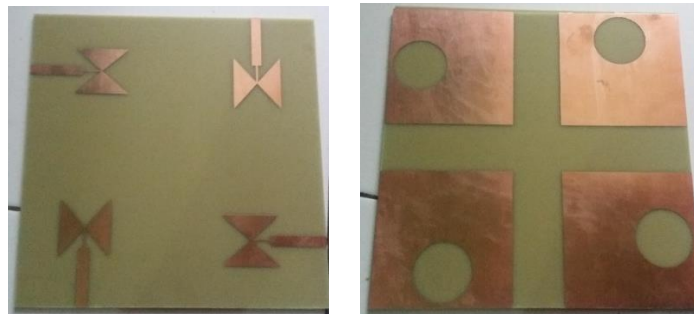
Gambar 3.24 Patch Dan Ground Antena Yang Sudah Dicetak (FR-4)
