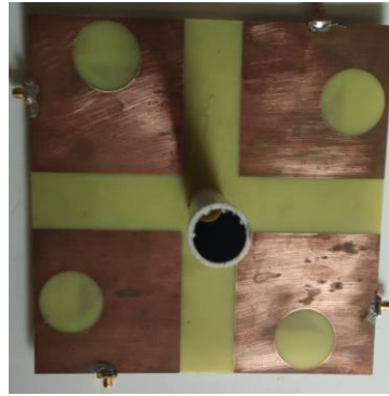
Gambar 3.26 Pemasangan Pipa Paralon Pada Titik Tengah Antena
