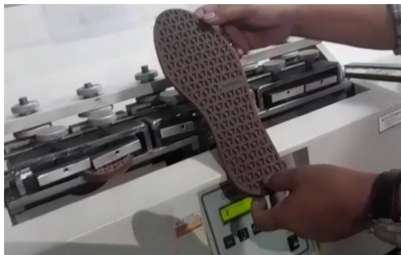
Gambar II.14 PT. Berkat Alas Sport Indo Proses Pengecekan Ketahanan Karet Oleh Tekanan Sumber: Data Pribadi (Diakses Pada 24 Desember 2019)
