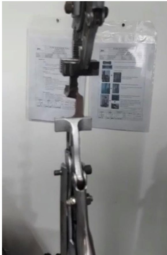
Gambar II.15 PT. Berkas Alas Sport Indo Proses Pengecekan Ketahanan Karet Oleh Tarikan Sumber: Data Pribadi (Diakses Pada 24 Desember 2019)
