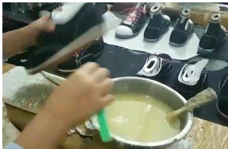
Gambar II.17 PT. Berkas Alas Sport Indo Proses Pengeleman Sepatu Lokal Duffel Sumber: Data Pribadi (Diakses Pada 24 Desember 2019)
