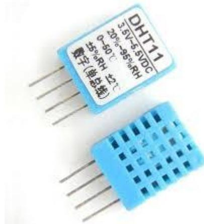
*Gambar 2.8 Sensor DHT11*
