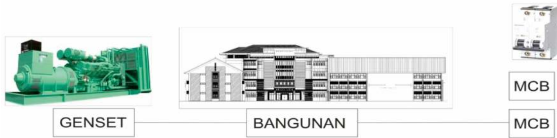
Gambar 5.12 Sistem Genset Pada Bangunan (Sumber: Google Image)
